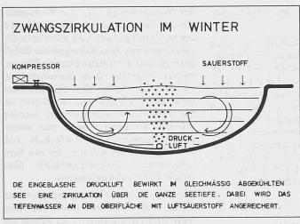
Bild 1. Wirkungsweise der Zwangszirkulation mit frei aufsteigenden Luftblasen
