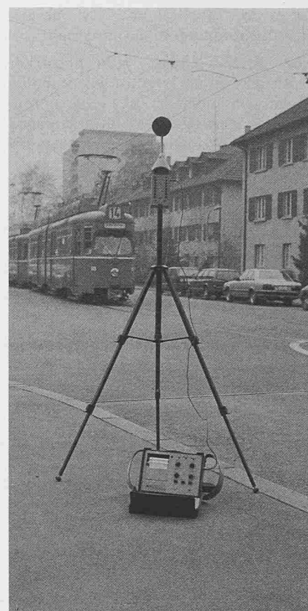
Bild 2. Modernes Lärmmessgerät mit Pegelschreiber zur Aufzeichnung des zeitlichen Lärmverlaufes
