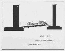
Bild 3. Einbau der Unterschottermatte
