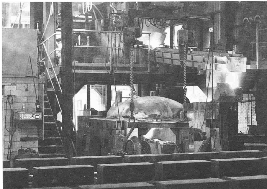
Die neue Heisswind-Kupelofen-Anlage für 10 t/h Gusseisen unterschreitet die Grenzwerte der Luftreinhalteverordnung (Bild: Strebelwerk, Rothrist AG)
