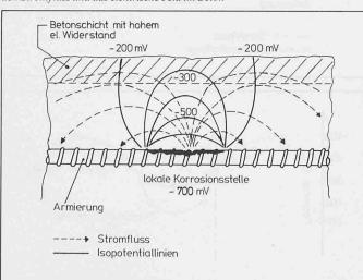
Bild 7. Prinzip der Potentialfeldmessung
