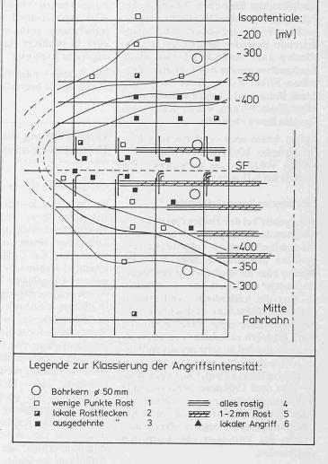
Bild 11 (rechts). Vergleich des Korrosionszustands der Armierung mit dem Potentialfeld (Fenster A aus Bild 10)
