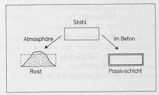
Korrosion von Stahl an der Atmosphäre und im Beton. Im Beton bildet sich im alkalischen Milieu des Porenwassers eine schützende Oxid-
