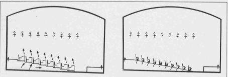
temperatur, wird die Zuluft mit mindestens 20 bis 21° C zugeführt. Je Sitzplatz können 30 bis 40 m³/h Zuluft einge-
