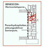
den Mauerwerken ein für allemal. Renescon-Injektionen bilden eine Horizontalsperre. Die Nässe steigt nicht mehr auf und das Mauerwerk kann austrocknen.
