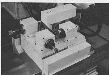
Werkstücktisch mit Schwenkeinheit Bild 3
