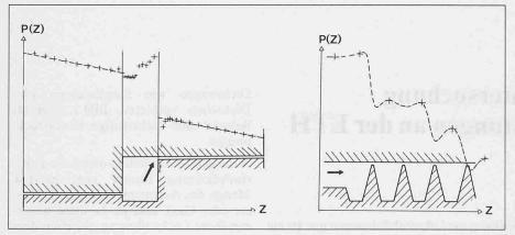
Dieses seit den Anfängen des Turbomaschinenbaus bekannte Optimierungsproblem hat schon mannigfaltige Lösungen gefunden (Beispiel vgl. Bild 2). Die energetische Verbesserung der Dichtwirkung des reinen Spaltes durch einen von Kammern unterbrochenen Spalt liegt nahe, wie z.B. R. Müllerin [6] anhand der Gleichung (4) erläutert hat.
