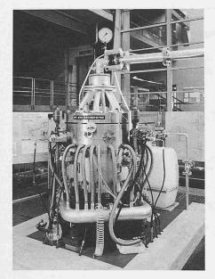
Hauptwasserspeisung V = 0...30 1/s P = 8 bar 10 Oelversorgung zum Statorantrieb E = 30 kW V = 92 1/min Stützlagerspeisung V = 98 1/min P = 25..90 bar 13 14 Rotorantrieb Ė = 42 kW N = 0..:3570 U/min 1
