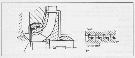
Bild 2. Meridianschnittbild zweier verschiedener Labyrinthdichtungen. a Stufenlabyrinth einer Hochdruckpumpe (vgl. Bild 1), b Labyrinth einer Dampfturbine (KWU, Mülheim/Ruhr)
