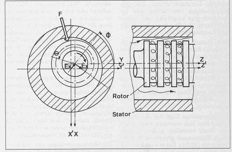
Situation im Bereich der Labyrinthdichtung bei exzentrisch laufendem Rotor
