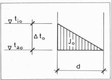
chend der Temperaturdifferenz  $\Delta t_0 = t_{i0}$  angenommen. Diese Konvention schliesst mit ein, dass dem Bauteil ein spezifischer Wärmeinhalt zugerechnet werden kann, welcher von der Wärmekapazität  $\rho \cdot c$ , von seiner Dicke d und von der spezifischen Temperaturdifferenz  $\Delta t_0$  abhängt.
