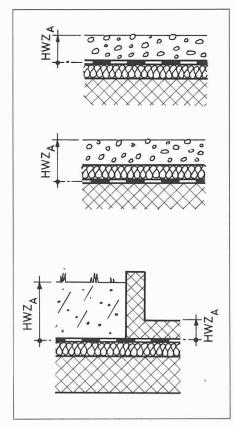
Bild 8. Vergleich des Abdichtungsschutzes bei Flachdächern
