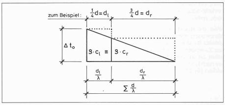
Bild 3. Homogener Querschnitt «2schichtig»
