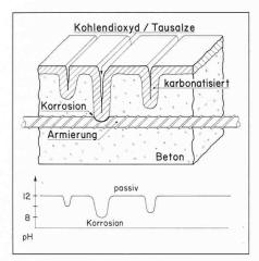
Bild 2. Lokale Korrosion des Armierungsstahls als Folge der Veränderung des pH-Wertes in teilweise karbonatisiertem oder versalzenem Beton
