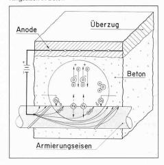
die Reduktion des an die Metalloberfäche gelangenden Sauerstoffs decken (Bild 4). Negative Chloridionen werden aus der Umgebung des Armierungsstahles abtransportiert und zur Anode gebracht, wo sie zu Chloridgas oxidieren und in die Atmosphäre entweichen.
