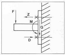
Bild 8. Druckbelastung D zwischen Anschlusskonstruktion und Untergrund
