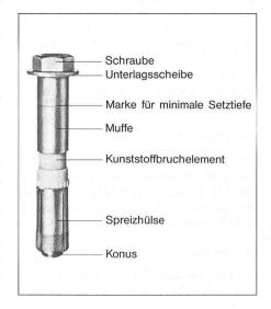
Spreizhülse und presst diese gegen die Bohrlochwandung. Dabei behält die Spreizhülse ihre Lage gegenüber dem Bohrloch bei. In einer Kombination von Reib- und Formschluss können sodann Zugkräfte in den Beton eingeleitet werden. Bei Beanspruchung durch Querkräfte unterliegt der Dübel einer zusammengesetzten Beanspruchung bestehend aus Scherung, Biegung und
