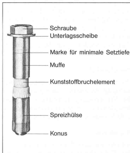
Bild 1. Schwerlastanker Hilti® HSL
