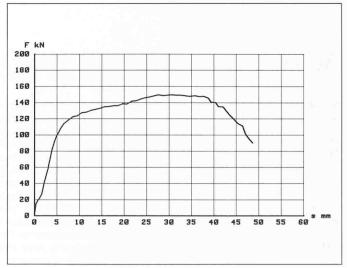
Durch den Nachspreizvorgang wird ein sehr duktiles Bruchverhalten erzielt. Somit kann bei Mehrfachbefestigungen bei Überlastung eines Dübels eine Lastumlagerung auf benachbarte Dübel erfolgen. Insbesonders wird der gefürchtete «Reissverschlusseffekt» vermieden, bei dem sämtliche Befestigungseleeiner Mehrfachbefestigung plötzlich versagen, nachdem eines davon überlastet worden ist.
