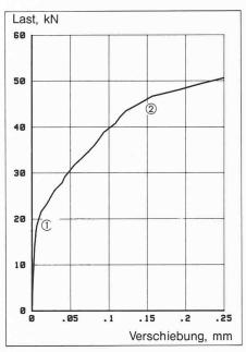
Bild 5. Last-Verschiebungskurve HSL M16, vergrösserter Ausschnitt
