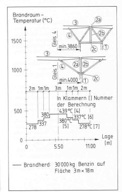
Bild 32. Temperaturverteilung im Geleisebereich (Berechnungen 4 bis 7)
