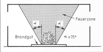
Bild 6. Die Feuerzone, durch geneigte Seitenflächen abgegrenzter Raum über dem Brandherd
