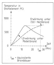
Bild 11. Ermittlung der äquivalenten Branddauer
