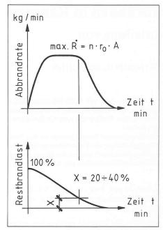
Bild 4. Abbrandrate bei brandlastgesteuertem Brand (Sauerstoffüberschuss)
