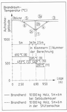
Bild 33. Temperaturverteilung im Bereich Perron 1 (Berechnungen 8 bis 12)
