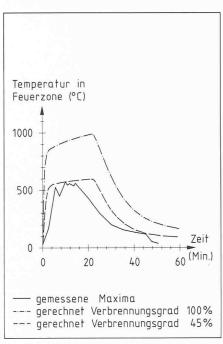
Bild 15. CTICM-Versuch Nr. 3: Gemessener Maximalwert und gerechnete Werte bei Verbrennungsgrade 45 % bzw. 100 %
