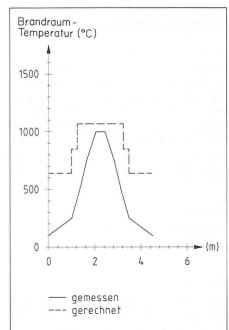
Bild 20. Boreham Wood-Versuch Nr. 2: Gemessene und gerechnete Temperatur-Verteilung im Parkhaus
