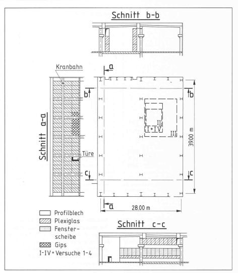
Bild 12. CTICM-Brandversuche. Brandraum mit den vier Brandherden
