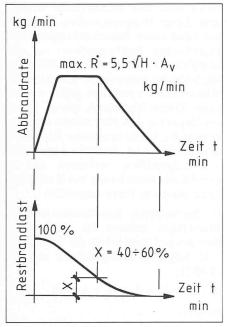
Bild 3. Abbrandrate bei ventilationsgesteuertem Brand (Sauerstoffdefizit)
