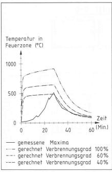
Bild 13. CTICM-Versuch Nr. 1: Temperatur-Zeit-Verläufe der Lufttemperaturen in der Feuerzone. Im Versuch gemessener Maximalwert und gerechnete Werte bei Annahme eines Verbrennungsgrades von 40%, 60% und 100%
