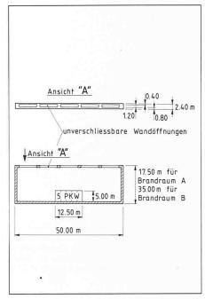
Bild 21. Grundriss und Seitenansicht der Einstellhalle mit unverschliessbaren Seitenöffnungen in einer Seitenwand
