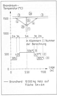
Bild 31. Temperaturverteilung im Perronbereich (Berechnungen 1 bis 3)
