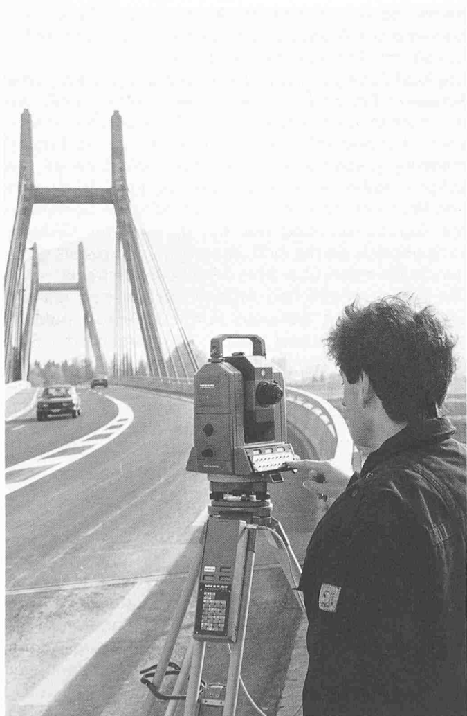
Ingenieur- und Präzisionsvermessung mit Informatik-Theodolit
