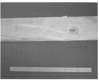
Qualität bei Schnittholz ist das Resultat eines Ausleseprozesses (Sortierung). Die Auslese geschieht aufgrund von Strukturmerkmalen und eventuellen Schädigungen, die beim aufgeschnittenen Holz meist gut sichtbar sind. Das Mass der Beeinträchtigung ist auch von der Art der Verwendung abhängig: Die Tragfähigkeit des Holzes wird durch die im Bild ersichtlichen Verfärbungen (Bläue und Rotstreifigkeit) nicht gemindert
