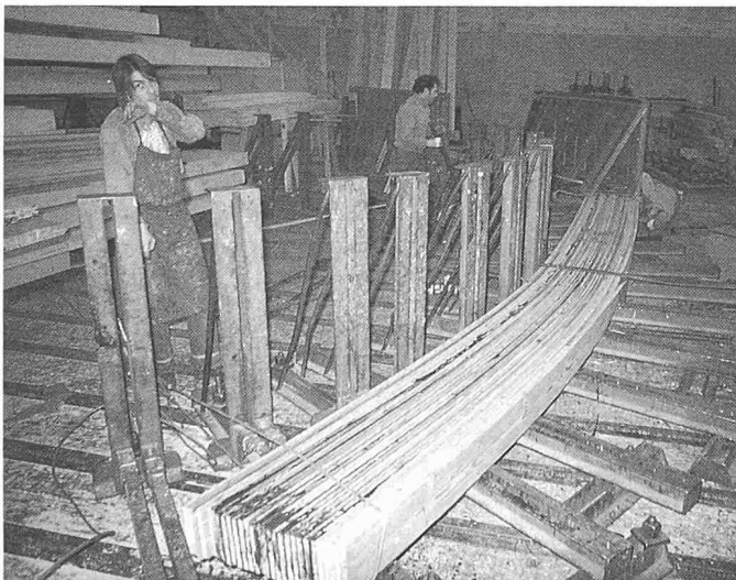
Bild 3. Auch beim Brettchichtholz hat die Materialauslese – insbesondere der Randlamellen – einen deutlichen Einfluss auf die Produktequalität. Heikler ist allerdings die Verarbeitungsqualität – hier im Bild das Spannen als Teil des Verleimungsvorgangs –, die durch geeignete Qualitätssicherungsmaßnahmen zu gewährleisten ist
