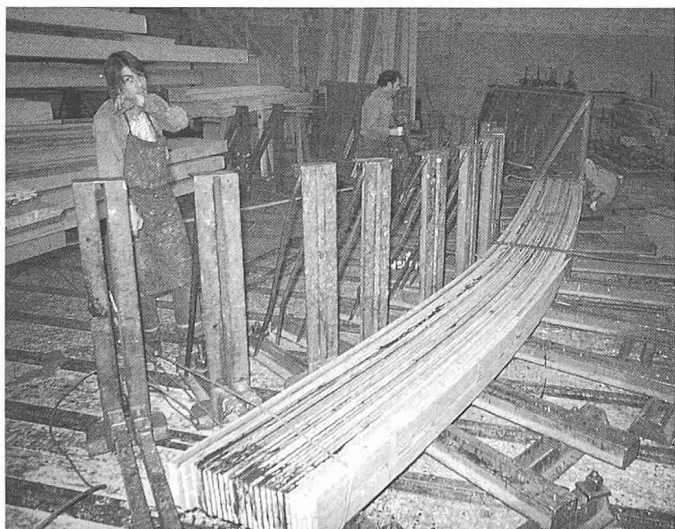
Bild 3. Auch beim Brettschichtholz hat die Materialauslese – insbesondere der Randlamellen – einen deutlichen Einfluss auf die Produktequalität. Heikler ist allerdings die Verarbeitungsqualität – hier im Bild das Spannen als Teil des Verleimungsvorgangs –, die durch geeignete Qualitätssicherungsmassnahmen zu gewährleisten ist
