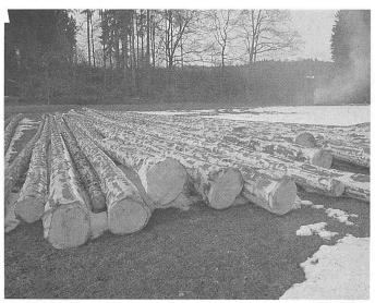
Bild 1. Beim Rundholz ist die Beurteilung der Qualität schwierig: Die qualitätsbeeinflussenden Merkmale wie Äste, Schrägfasrigkeit, Buchs, mechanische Schädigungen usw. sind nur schwer zu erfassen
