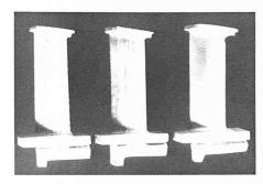
Vergleich verschiedener Giessverfahren für Triebwerk-Rotorschaufeln (Werkstoff B1914), herkömmlich gegossen, gerichtet, erstarrt und als Einkristall erstarrt (von links nach rechts). (Werkfoto Sulzer)
