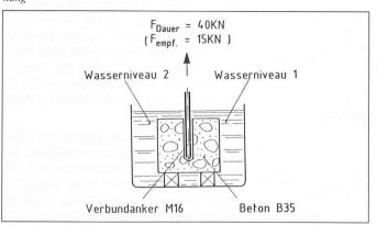
Bild 6. Langzeitverhalten unter Einfluss extremer Feuchtigkeit
