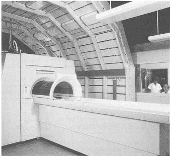
Magnetresonanz - Tomograph mit sichtbarer magnetischer Abschir-
