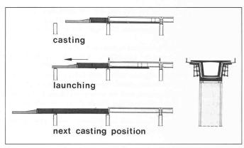
Bild 6.  $Gleit lager\ zwischen\ Matrizenboden\ und\ neubetoniertem\ Feld$
