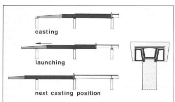
Bild 5. Brückenträger mit Schalungsklappen verbunden
