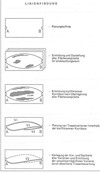
Bild 3. Ablauf der Linienfindung in der stufenweisen Strassenplanung
