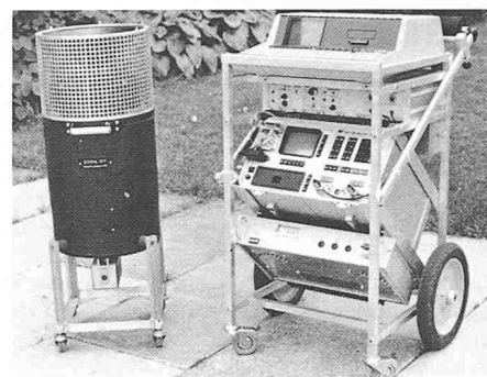
Bild 2. Apparatur zur raschen, normgerechten Messung von D_{nT,w} und L_{nT,w}
