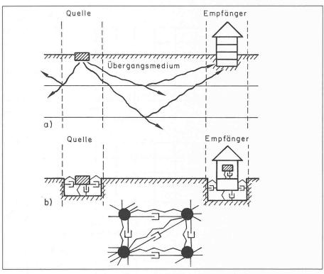
Bild 1. Modellvorstellung zur Untersuchung von Erschütterungen: a) Bereiche, b) Darstellung als schwingfähige Elemente
