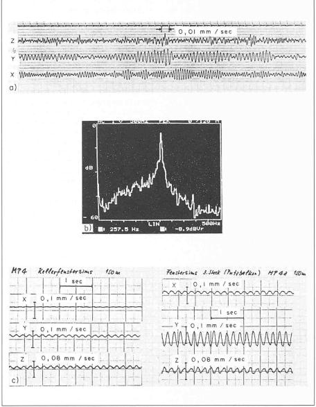
Erschütterungen bei der Durchfahrt einer Lokomotive Ae 6/6 bei einer Geschwindigkeit von 60 km/Stunde, Messpunkt an Tunnelwand: a) Zeitverläufe, b) Frequenzinhalt
