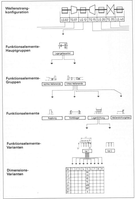
Konstruktion einer Turbinenwelle; Teilschema der Funktionselemente-Auswahl Bild 8.
