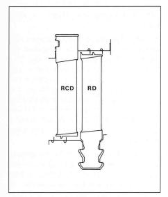
Bild 3. Reaktionsstufe mit RCD Leit- und RD-Laufschaufeln
