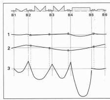
Wellenlinie eines Mitteldruck-Rotors; 1 Biegelinie; 2 Biegelinie nach vertikaler Positionierung der Lager; 3 Biegemomentenlinie mit Nulldurchgängenbeilagern
