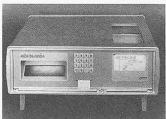
hüllende, Frequenzanalyse usw. gehören ebenso zum Vibras-2004 wie die standardmässig eingebaute Frequenzanalyse oder die batteriegepufferte Echtzeituhr. Des weiteren zeichnet sich das robuste Schweizer Produkt durch seine überdurchschnittliche Triggermöglichkeiten, die hohe Messgenauigkeit, den Netz- und Batteriebetrieb und eine einfache Bedienung aus.
