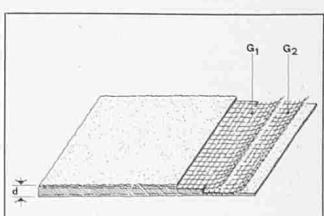
dehnen und Schwinden von statisch beanspruchten Gebäude Teilen. Die aus Glas- oder Steinwollplatten bestehende Isolation ist dampfdurchlässig. Wasserdampf, der durch das Wohnen entsteht, kann ungehindert nach aussen entweichen und wird durch die Hinterlüftung von
