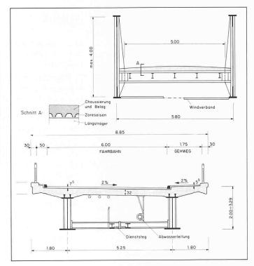
Bild 2 (rechts). Querschnitte der alten (oben) und neuen Brücke (unten)
