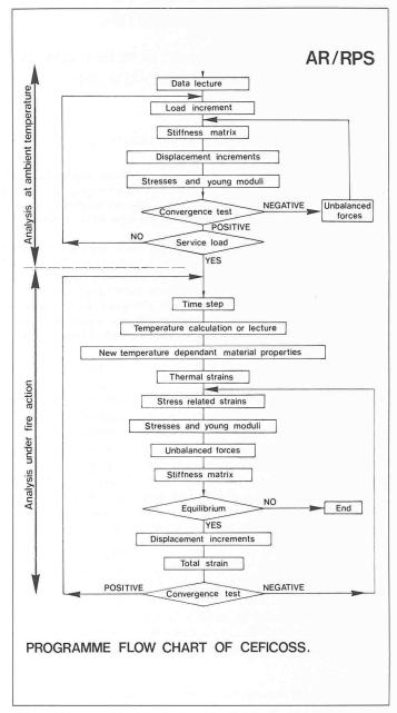
Bild 4. Programmablaufplan der Brandsimulation
