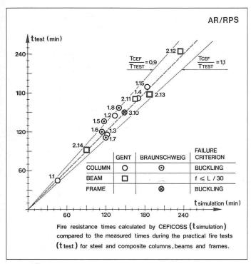
Bild 9. Übersicht über die verschiedenen Feuerwiderstandstests
