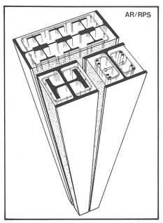
Bild 18. Rechteckige Verbundquerschnitte mit sichtbaren Stahlflanschen
