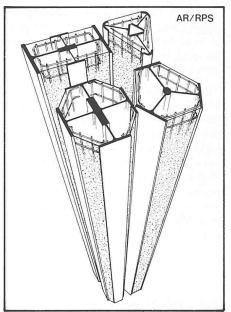
Bild 19. Polygonale Verbundquerschnitte mit sichtbaren Stahlflächen
