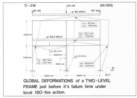
Gesamtverformung einer Rahmenkonstruktion Bild 12.
