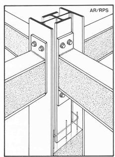
Bild 20. AF-Verbundbauweise mit Träger-Stützen-Anschluss
