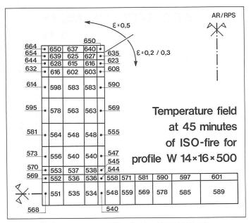
Bild 5. Berechnetes Temperaturfeld im Stahlprofil W 14×16×500
