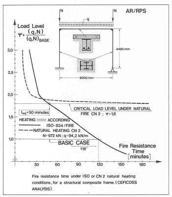
Bild 16. Rahmenberechnung unter ISO- und Naturbrand
