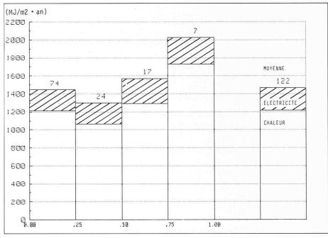
Figure 4. Ide total (E) en fonction du taux de ventilation-climatisation: catégorie  $\emptyset$  (le chiffre indique le nombre d'objets de la classe)
