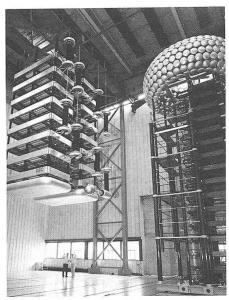
BBC-Quadriventil für eine 500-kV-Hochspannungs-Gleichstromübertragungsanlage (HGUe) bei der Hochspannungstypenprüfung (1400 kV BIL) im Boveri-Hochspannungslabor Schweiz (Foto BBC)
