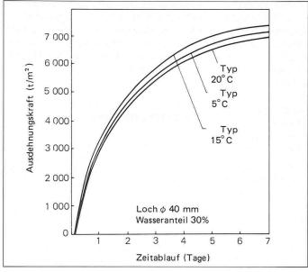
Bild 4. Änderung der Ausdehnungskraft über der Zeit
