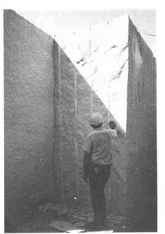
Bild 6a und b. Werksteingewinnung mit Expansionsmörtel
