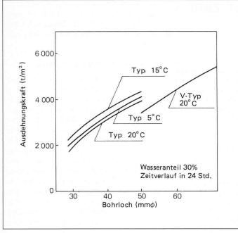
Bild 2. Zusammenhang zwischen Ausdehnungskraft und Lochdurchmesser
