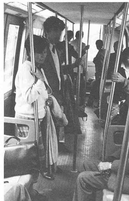
Bild 7. Mit nur 2,06 m Lichtraumbreite ist das Rollmaterial des VAL auch optisch recht schmal. Obwohl pro Wageneinheit 32 Sitzplätze angeordnet sind, zieht man es bei einigem Andrang schon vor, zu stehen – Ergebnis einer in Anbetracht der sonst so grosszügigen und unkonventionellen Konzeption nicht ganz verständlichen Sparsamkeitsanwendung. (Bild: Verfasser)
