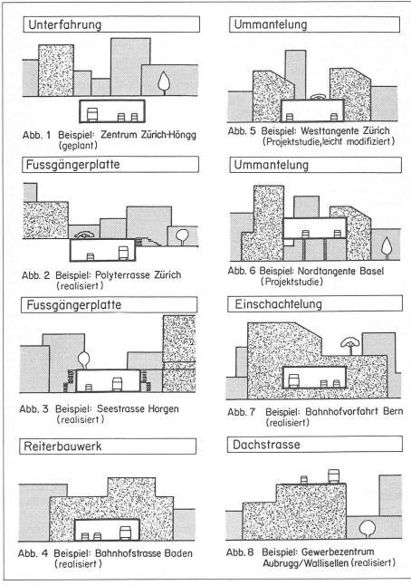
Bild 1. Typen baulich integrierter Strassen
