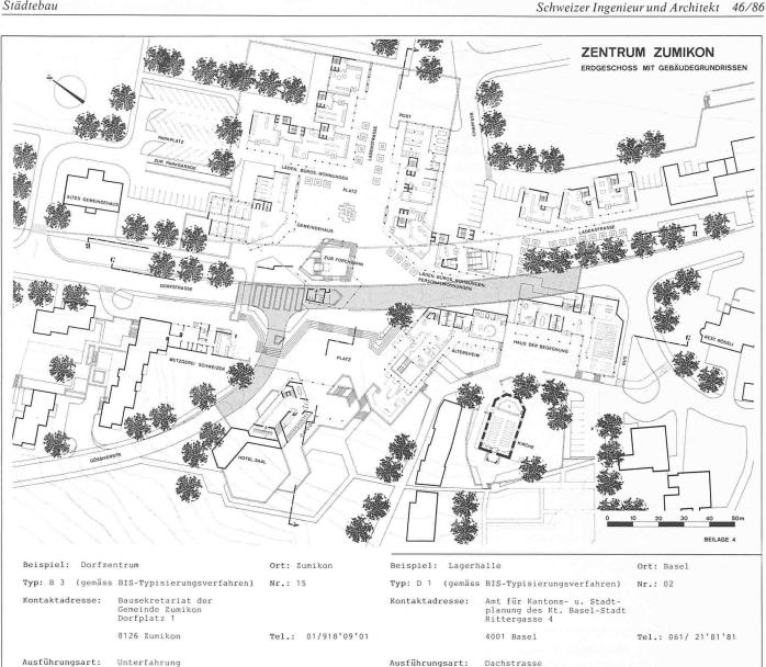
Im Zusammenhang mit der Tieferlegung der Forchbahn im Bereich des Dorzentrums Zumikon hat man sich entschlossen, auch die Strasse unterirdisch zu führen, um so die Zerschneidung des Dorfkerns zu vermeiden. Diese Verlegung der Verkehrsträger unter den Boden ermöglichte eine äusserst fussgängerfreundliche Dorfkerngestaltung. Kurzbeschrieb :
