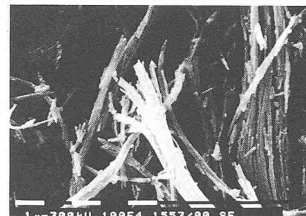
Bild 3. Asbestfasern: Man beachte vor allem die longitudinale Aufspaltung der Fasern in feinste Fibrillen. Vergrößerung 10 000 mal. (Quelle: SUVA)
