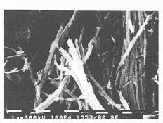
Bild 3 Asbestfasern: Man beachte vor allem die longitudinale Aufsplitterung der Fasern in feinste Fibrillen. Vergrösserung 10 000 mal. (Quelle: SUVA)
