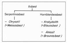
Bild 1. Asbestarten (Quelle: SUVA)
