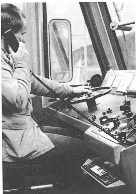
Führerstand mit Zugfunk in einer Lokomotive der Bern-Lötschberg-Simplon-Bahn (BLS), für welche Brown Boveri das Zugfunksystem einschliesslich Versorgung in den Tunnels lieferte.
