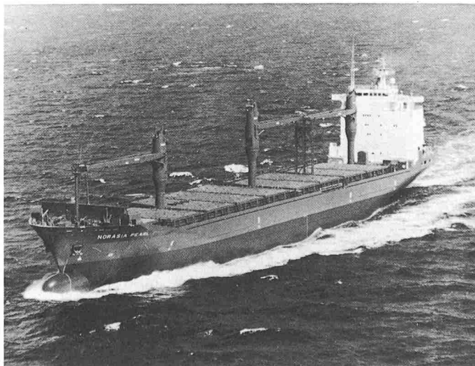
Bild 1. MS «Norasia Pearl» mit der ersten BBC-Nutzturbine (Foto BBC)
