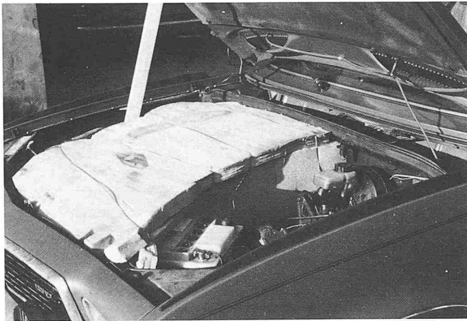
Bild 1. Isolierender Mantel um Motor
