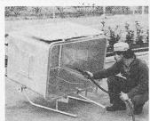
struktion ist mit Rollen ausgerüstet und ermöglicht dank der speziellen Kammhalterung eine sichere Handhabung ohne Kraftaufwand bis in die Wasch-Fixstellung.
