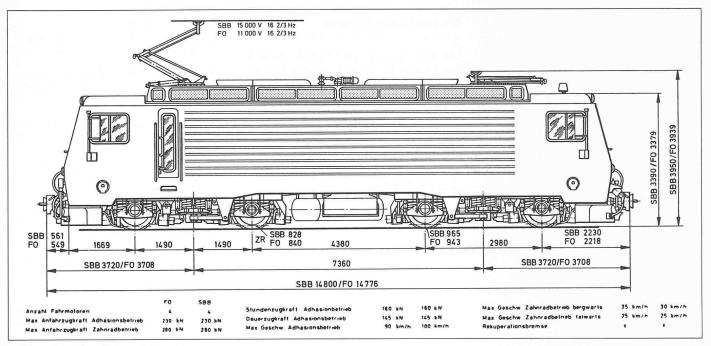
Bild 2a. Schmalspur-Zahnradlokomotive HGe 4/4 II SBB-FO, mit erstmalig realisiertem Differentialantrieb (SLM), Radsätzen mit gefedertem Seitenspiel und elektrischem Antrieb mit Rekuperationsbremsen in Stromrichtertechnik mit Phasenanschnitt
