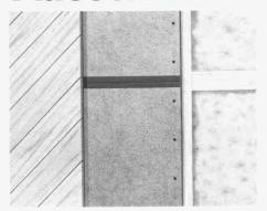
PAVATEX-ISOLAIR-Baustoffe sind Holzfaserplatten mit einem Bitumengehalt von ca. 15%. Frei von teerhaltigen Derivaten stellen die atmungsaktiven Platten eine baubiologisch wertvolle Lösung dar. Leichte, grossflächige Formate ermöglichen eine wirtschaftliche und rationelle Verarbeitung. Verlangen Sie ausführliche Unterlagen über den Einsatz von PAVATEX-ISOLAIR-Platten. Rufen Sie uns an: 042/365566.
