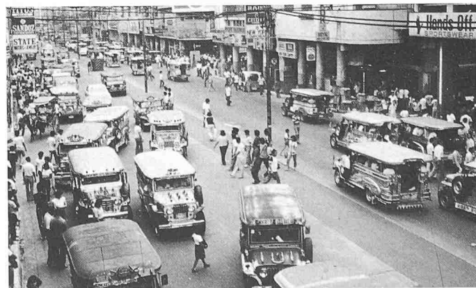
Bild 3. Der «Jeepney», mit einem Dach und zwei Längsbänken versehen, ist für den Transport von 15 bis 17 Passagieren umfunktioniert
