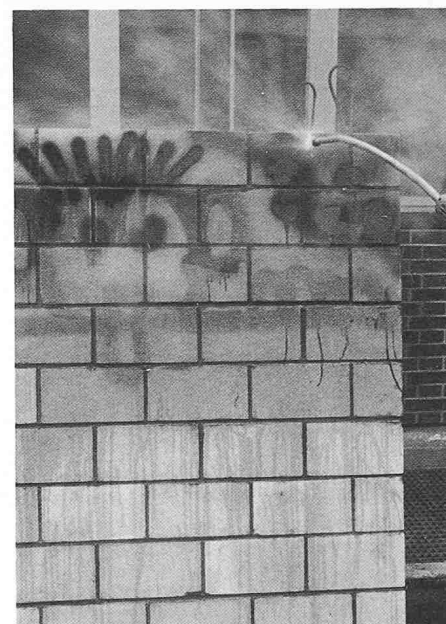
Bild 3. Reinigungsversuche mit Hochdruckreinigungsgerät
