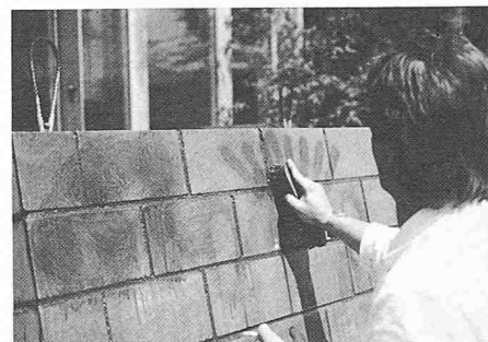
Bild 2. Reinigungsversuche mit Drahtbürste
