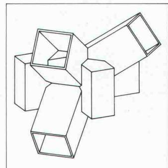
Die Montage erforderte demnach höchste Präzision in der Werkstatt. Dank dem Einsatz des dreidimensionalen CAD-Systems konnte das Problem der Schnittfiguren in den komplizierten Knoten schnell und kostengünstig gelöst werden.
