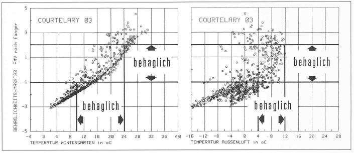
Bild 6. Abhängigkeit der Wintergartentemperatur von der Aussentemperatur für die Messobjekte in Adliswil und Courtelary im Monat März 1984. Die Punkteansammlungen bestehen aus den einzelnen Messwerten. Aufgetragen sind alle Messwerte ohne Einschränkungen, also auch diejenigen mit Benutzereinfluss
