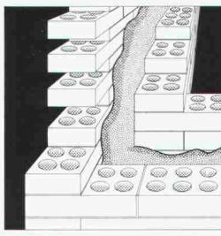
STARTEX in Hohlräumen des Zweischalen-Mauerwerkes (begünstigt Wärmespeicherfunktion des inneren Mauerwerks)
