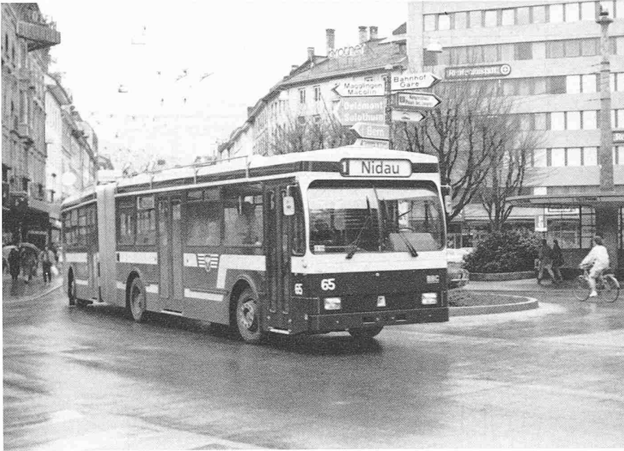
Einer der sechs neuen, mit Gleichstromsteller ausgerüsteten Gelenk-Trolleybusse der Stadt Biel (Foto BBC Brown Boveri)
