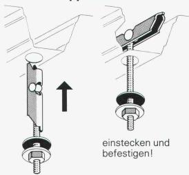
Schnelle, sichere und wirtschaftliche Aufhänge-Elemente für die Befestigung von Leitungen, Rohren, Kanälen usw. direkt an Blechdecken.
