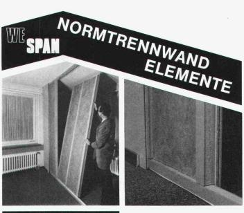
Trennwandelemente für Neubauten • Umbauten individuelle Raumgestaltung Die ideale Holztrennwand mit hoher Schall- und Wärmeisolation. Schnelle, saubere und einfache Montage auch in bewohnten Räumen. Schalldämmwert It. EMPA-Test 45 dB. Wandstärke 80 mm. Normgrösse 260 x 93 cm.
