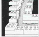
STARTEX in Hohlräumen des Zweischalen-Mauerwerkes (begünstigt Wärmespeicherfunktion des inneren Mauerwerkes)
