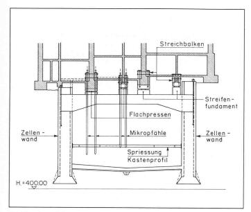
Bild 7. Querschnitt (Bauzustand Mikropfähle)
