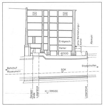
Bild 9. Längsschnitt Unterfangungsdecke (Lastübertragung)
