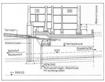
Bild 14. Längsschnitt Jet-Voraussicherung Hirschengrabentunnel
