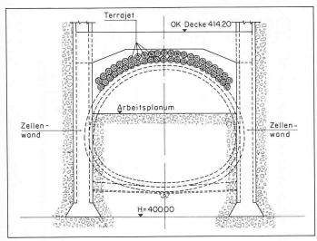
Bild 13. Querschnitt Jet-Voraussicherung Hirschengrabentunnel
