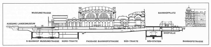
Bild 10. Längsschnitt durch die projektierte Unterführung Bahnhofstrasse
