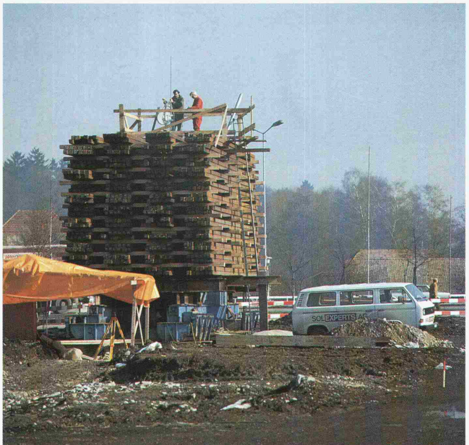
Pfahlbelastungsversuch Viadukt Neugut
